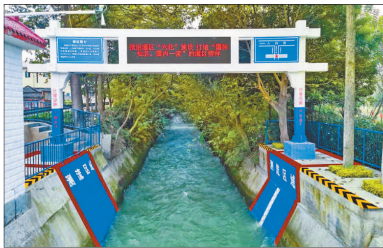
上图:都江堰宝瓶口测站的高电压缆道式量水秤。这种秤有缆索牵引、靠声学多普勒流速剖面仪等收集数据。
