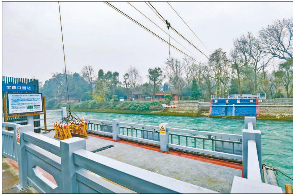
上图:都江堰宝瓶口测站的高电压缆道式量水秤。这种秤有缆索牵引、靠声学多普勒流速剖面仪等收集数据。
