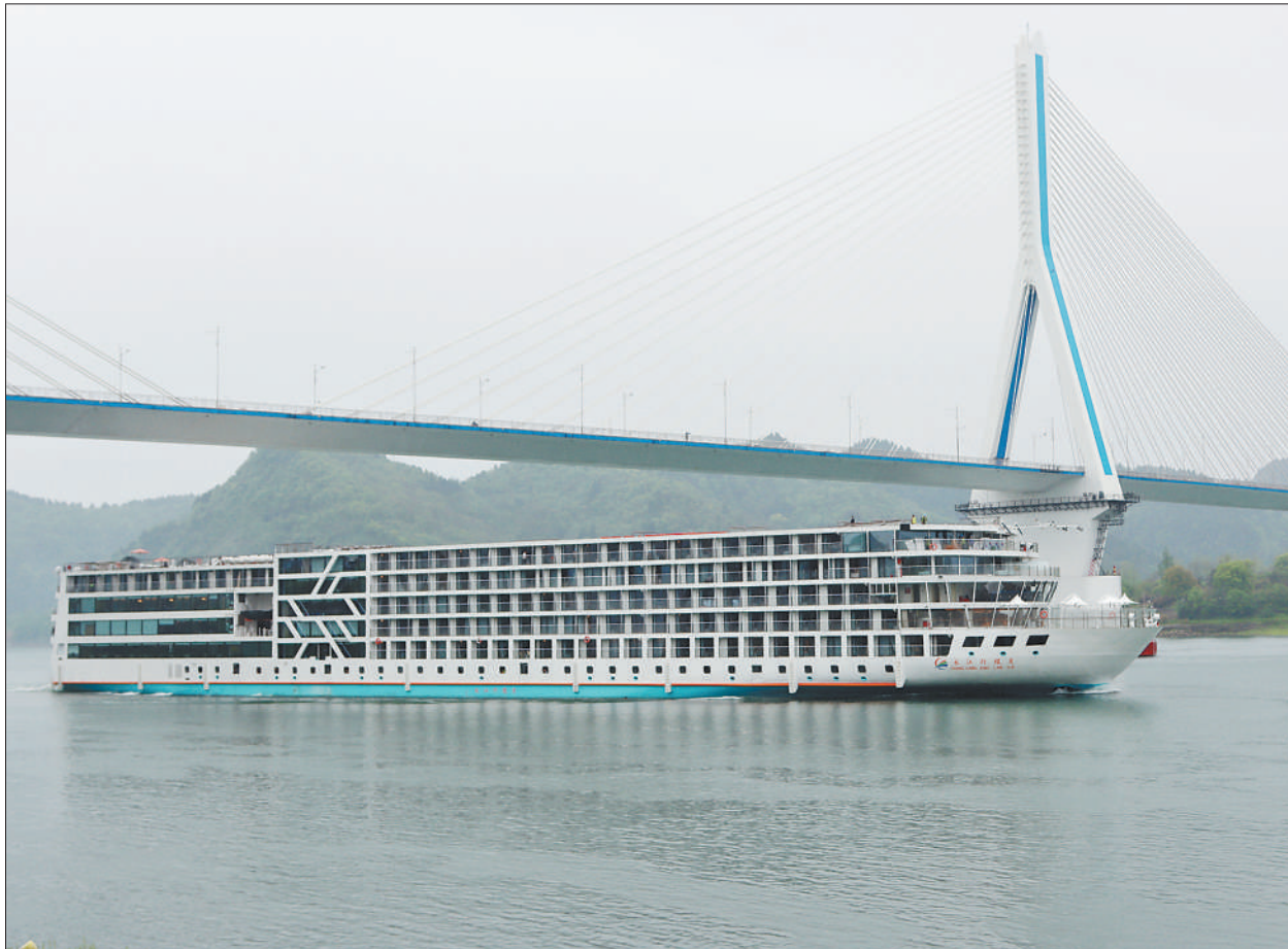
近日,湖北宜昌“长江江·揽月”号游轮从宜昌港载客启程首航重庆。作为“绿色+智能”游轮,“长江江·揽月”号搭载增程式发电机组、高性能电控及电机系统,并应用大型中央直流变频空调系统,船舶空调系统综合节能20%,综合续航可达1500公里。游轮总长约150米、型宽近23米、总吨位近1.7万吨,可载客650人。
