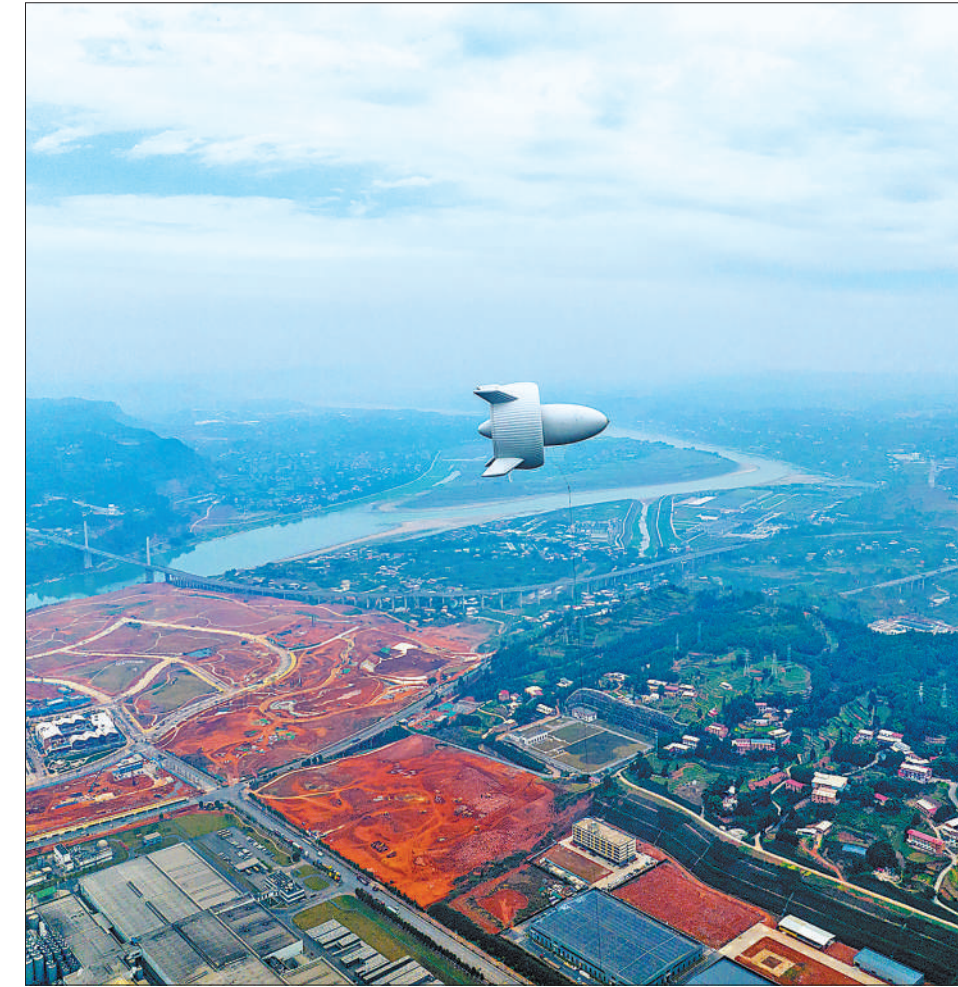
连日来，适用于城市环境的兆瓦级S2000浮空风力发电系统，在四川省宜宾高新区空域内进行并网发电测试，升空高度、发电功率、升阻比等主要参数均达到预期目标。此次试飞的浮空风力发电系统体积近2万立方米，最大额定功率可达3兆瓦。 图为1月8日，浮空风力发电系统在距地面约400米的空中进行并网发电测试。 庄歌尔摄（影像中国）
