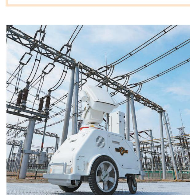
随着科技水平的不断进步,智能机器人被广泛应用于变电站设备的巡视领域。智能机器人利用视觉识别技术,通过测温热成像仪,能够自主排查设备发热隐患,及时了解变电站设备运行状态。
