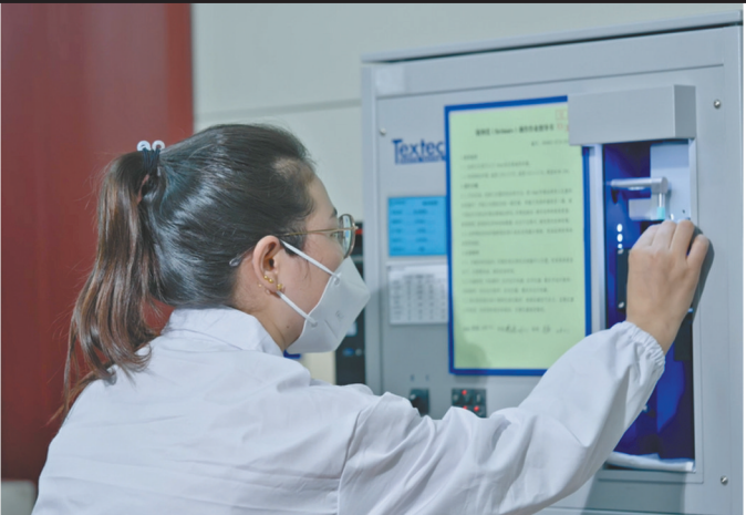
质检人员进行纤维拉伸强度测试
