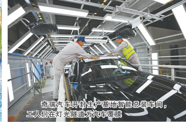
奇瑞汽车开封生产基地智能总装车间，工人们在灯光隧道为汽车覆膜
