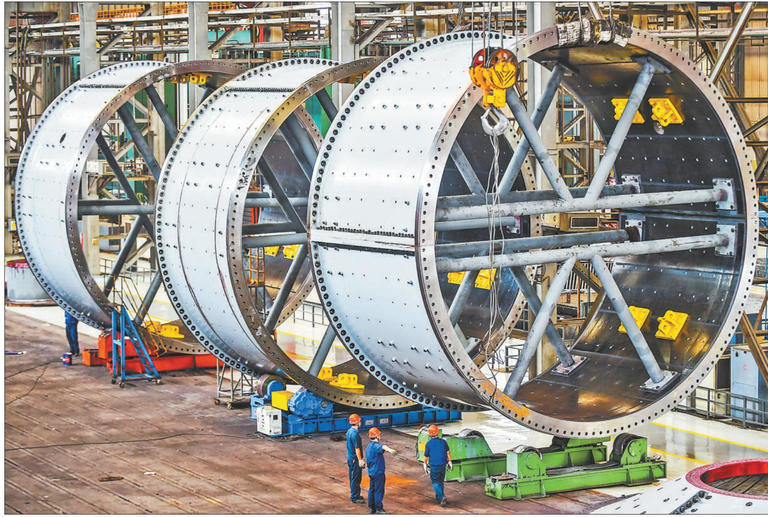
8月26日，位于河南省洛阳市的中信重工总装车间内，工人在起吊出口海外的超大规格矿业装备磨机筒体产品。
