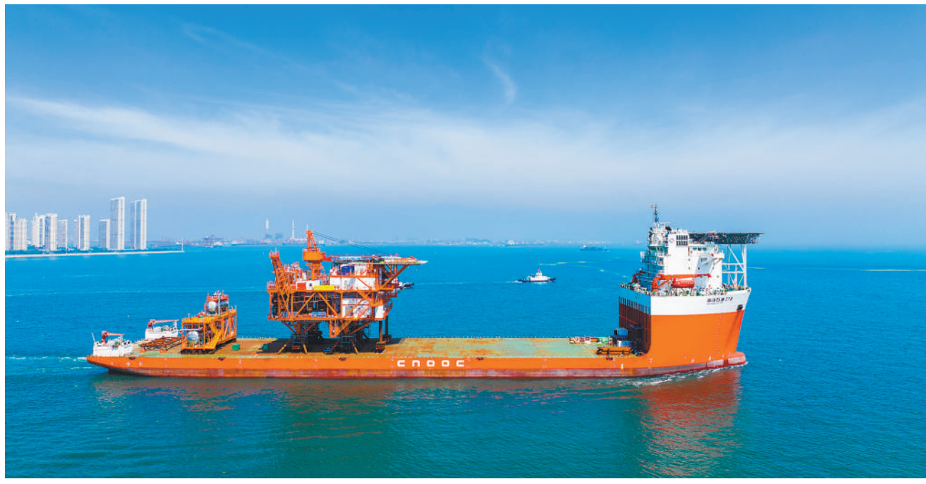
7月1日,山东青岛国际化高端装备制造基地,一座海上无人智能平台的上部组块完工起运。据悉,该组块将在海上运输约2000公里,到达珠江口盆地海域开启组块吊装作业,投产后将服役于该海域的西江油田,从事智能采油、设备运维等工作。图为当日该组块起运。杨雪梅摄(影像中国)
