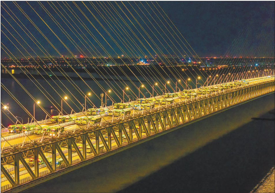
6月20日,常泰长江大桥主航道桥进行桥梁荷载试验。 韩鑫 赵振宇摄影报道 动载试验有三类。第一类为匀速试验,多辆重载货车形成编组,以不同的车速匀速驶过大桥,模拟日常车流状况。 第二类为刹车试验,重载货车将在桥梁最“脆弱”或关键位置进行急刹车,测试大桥在突发冲击下的稳定性和恢复能力。
