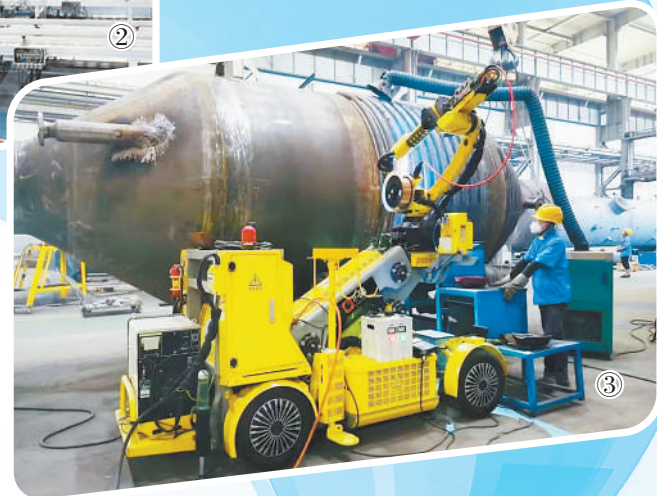
图①：心连心集团蓝色科技车用尿素生产线。 王恩豪摄 图②：新乡化纤氨纶智能生产线及自动落丝设备。 郑逢善摄 图③：威猛股份研发的焊接机器人“小萌”。 赵 云摄
