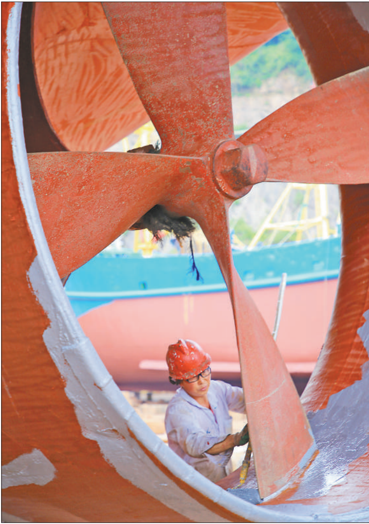
5月25日,浙江省玉环市坎门街道灯塔船舶修造厂,工人们対渔船进行除锈、刷漆、维修等检修保养工作。图为工人在刷漆。
