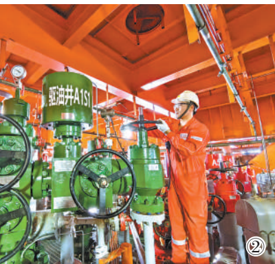
图①:实施我国首个海上CCUS项目的恩平15—1平台。黄显颖摄(人民视觉) 图②:生产人员正在打开二氧化碳驱油井采油树阀门。吴晨摄(人民视觉)
