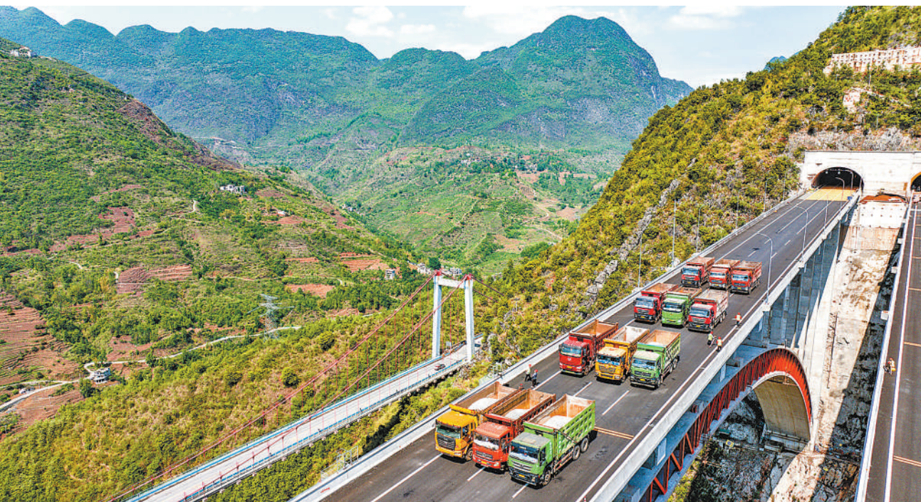
5月17日，贵州纳（雍）晴（隆）高速公路重点控制性工程——乌蒙山大桥进行静态荷载试验，检验桥梁结构受力性能和实际承载能力，为桥梁竣工验收提供科学依据。乌蒙山大桥主桥跨径270米，设计时速100公里，开通后将进一步完善路网结构、便利群众出行，助力当地经济社会高质量发展。
