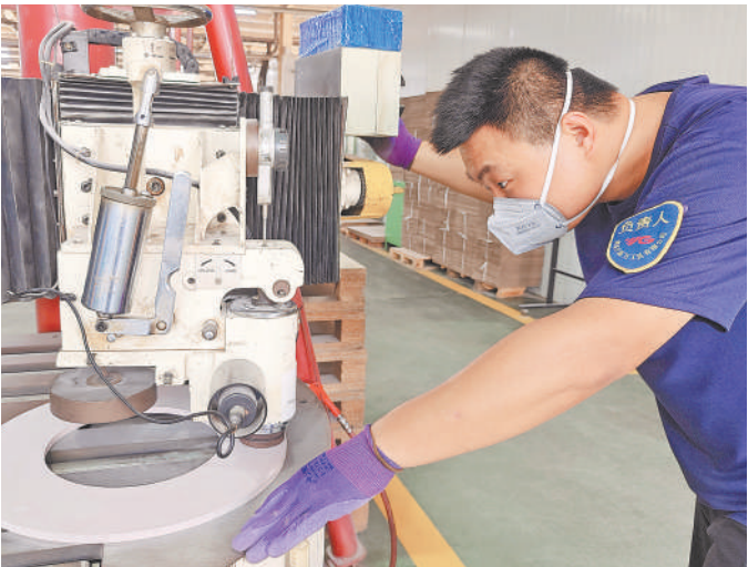
工人在对砂轮进行硬度检测。 青岛万基万工具有限公司供图
