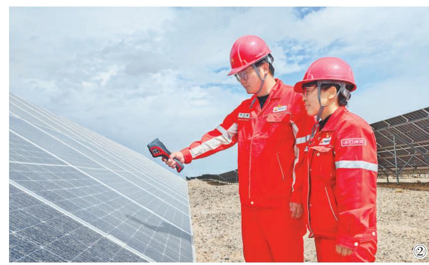
甘肃玉门，祁连山下，戈壁滩上，深蓝色的光伏面板铺展绵延。两人多高的面板旁，一个红色身影穿梭其间、不时停驻。他是田玉鑫，中国石油玉门油田新能源电站运维工程师，正手拿热成像仪，给几块重点面板做“体检”。
