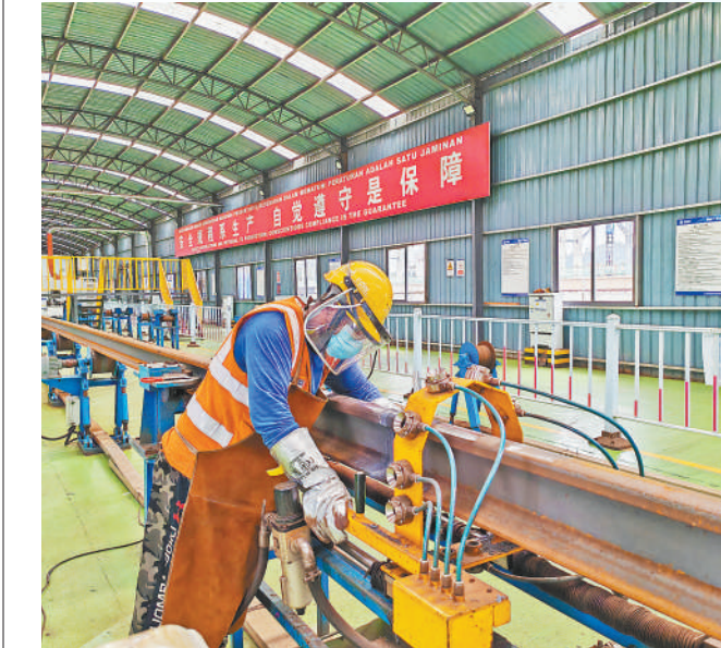
上图:马来西亚东海岸铁路项目铺轨基地的焊轨场内,工人在对焊头进行喷风冷却。 本报记者 管克江摄 右图:中马两国媒体记者在马来西亚东海岸铁路项目第十分部工艺展示厅采访项目相关负责人。 本报记者 杨一摄 版式设计:张芳曼
