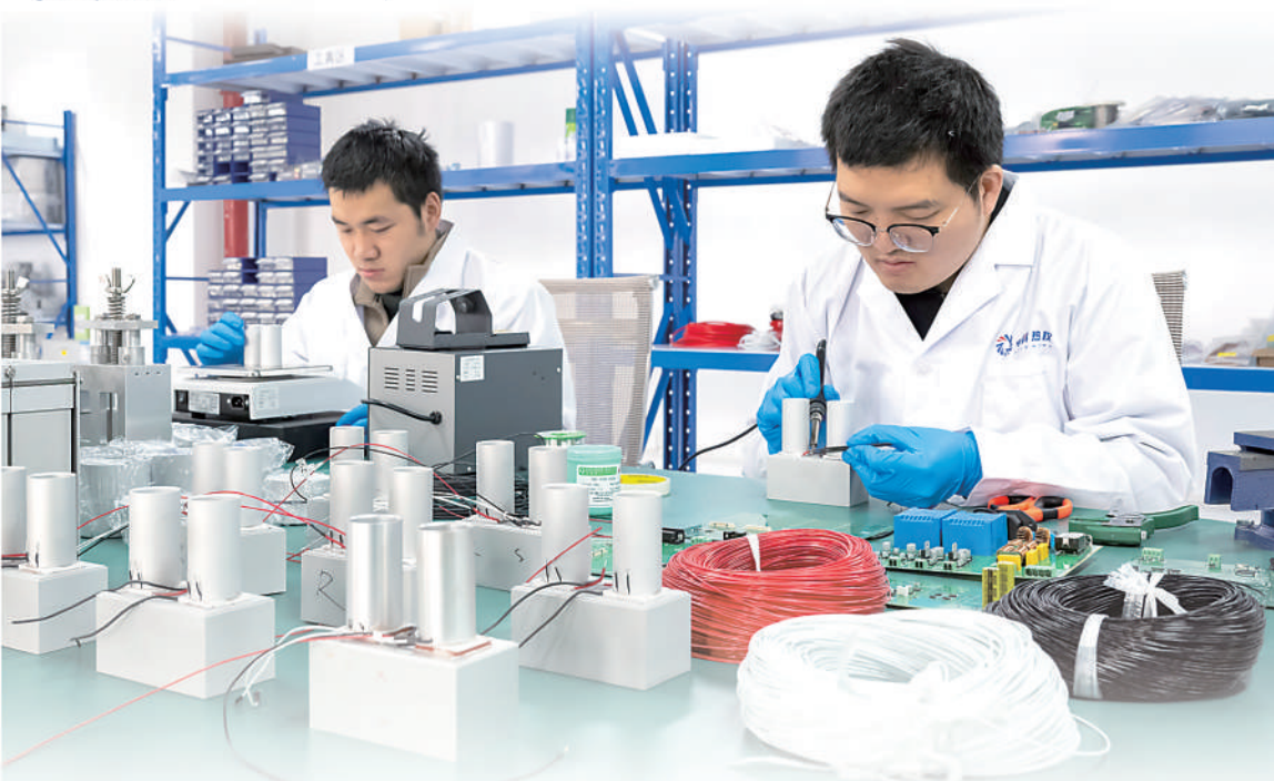
安徽中科热仪科技有限公司的工程师正在组装多通道微量热量仪热模块。
