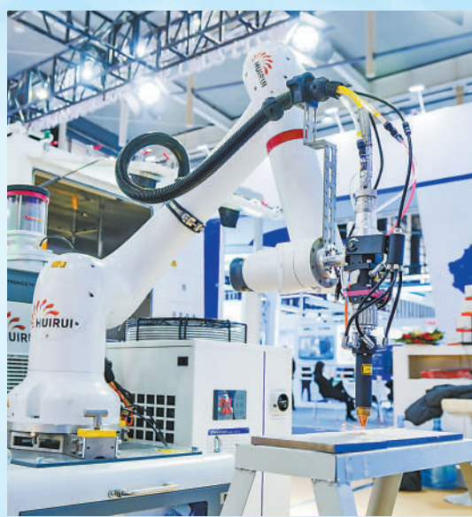
▲辉锐光电科技的工业机器人演示金属增材3D打印过程。 余乐摄(人民视觉)
