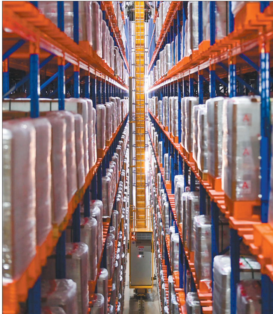
江西赣州市章贡区一家企业的智能自动化立体仓库,堆垛机器人在堆放产品。
