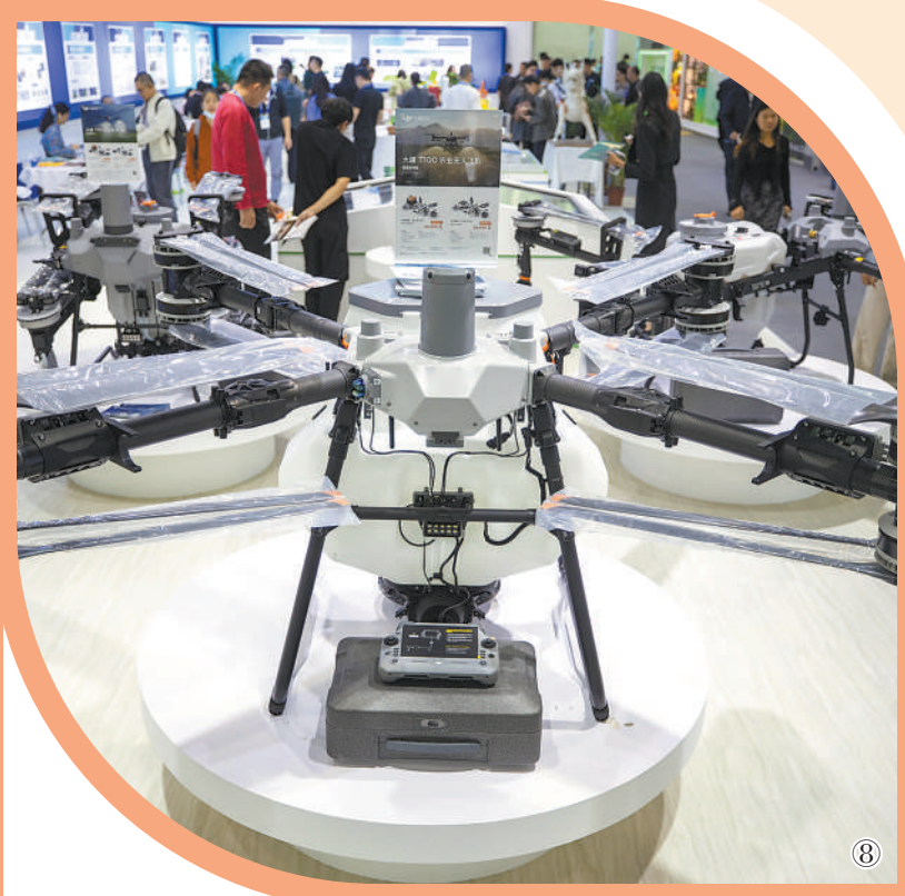
图⑧:展会上展出的T100农业无人机,配备AI算法系统和激光雷达,支持喷洒、播撒、吊运等多种作业场景。 图⑨:用于水产养殖的智能增氧机控制器,具备远程控制、定时等功能。 图⑩:由华南农业大学黄埔创新研究院研制的洋马蔬菜全自动移栽机,具备精准取投苗、株距无级调节、主动防堵等功能,可一次性完成取苗、投苗、接苗、打穴、植苗等作业。 图⑪:第二十一届农交会展馆外景。 本版图片除署名外均为本报记者张武军摄
