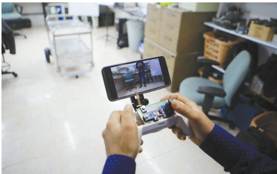
近日,巴勒斯坦工程师尤斯里·塔尔德研发出一种“快速机器人”,可在医院隔离治疗的新冠病人提供快速食物和药品服务。该机器人由传感器、摄像头、GPS定位追踪器、雷达等部件组成。图为尤斯里·塔尔德操作“快速机器人”。
