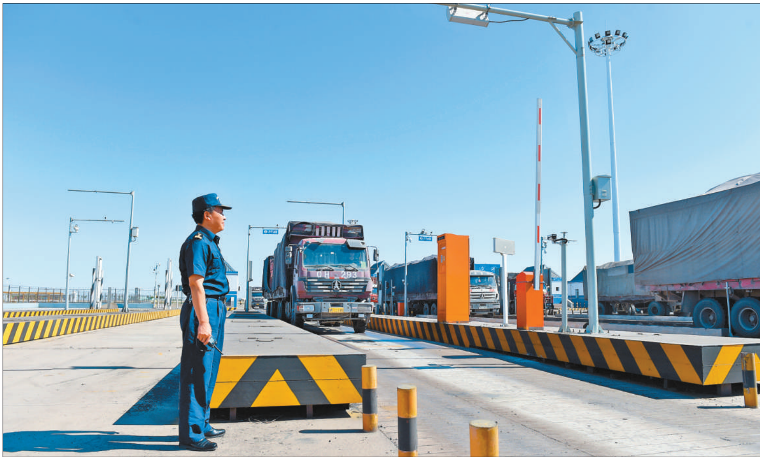
6月13日,内蒙古额济纳旗策克口岸的跨境运输车辆正在快速通过“智能卡口”。策克口岸日前试行“智能卡口”,跨境运输车辆可在提前申报模式下进境到达卡口,进行车牌号自动识别,自动放行完成整个通关流程。预计6月底,额济纳海关将正式运行“智能卡口”系统,届时从入境到放行,将由原来的两天时间缩短至35—50秒。
