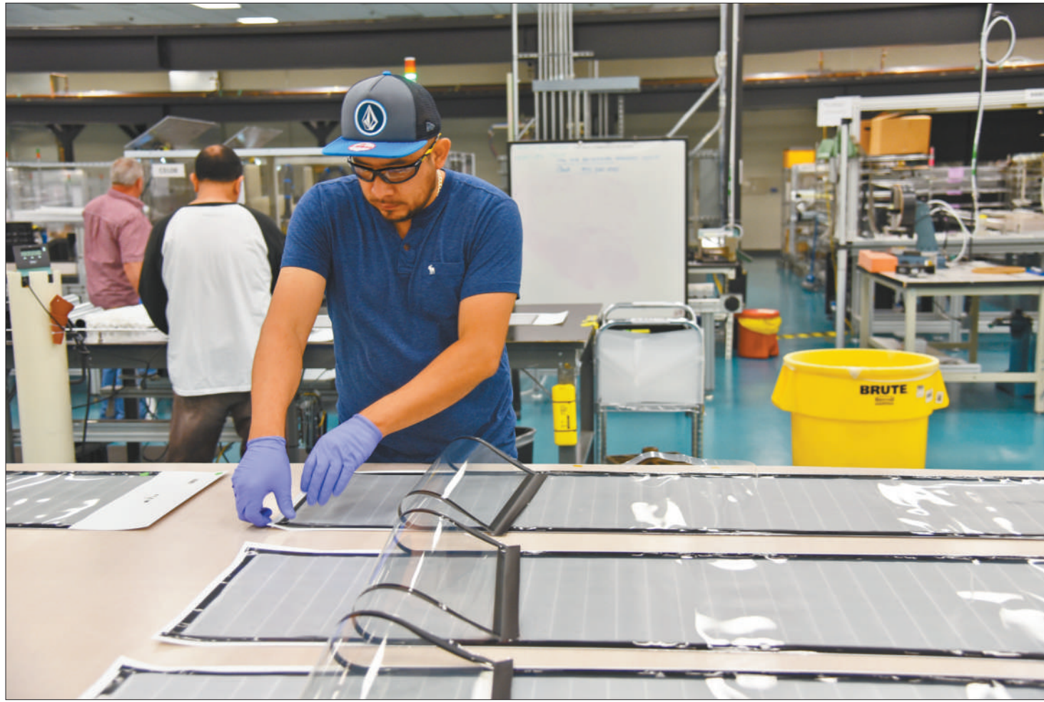
美国加州硅谷，米亚索能车间里的研发人员正在对薄膜太阳能电池芯片进行检测安装。
