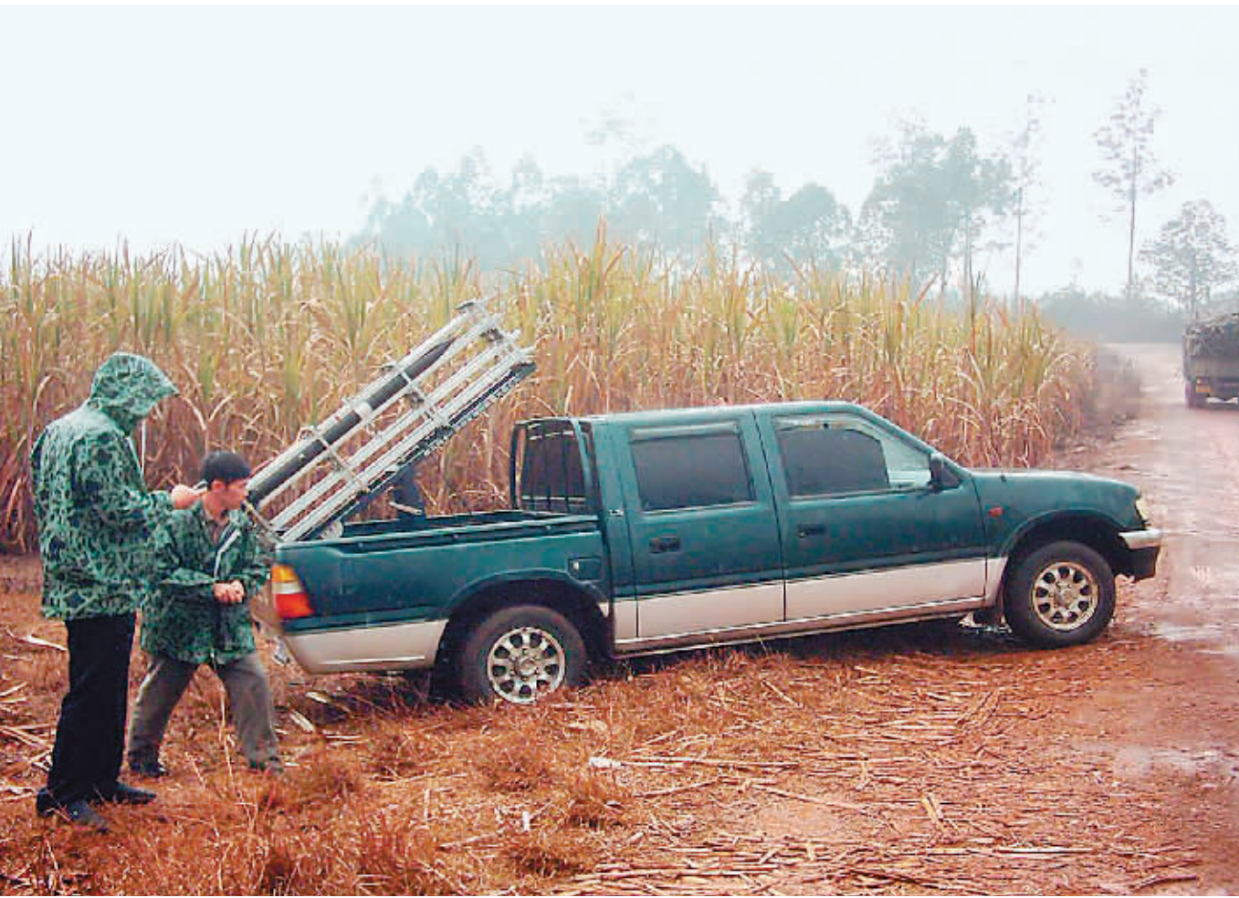
图为广西扶绥县气象局正在发射火箭弹,实施人工增雨作业。
