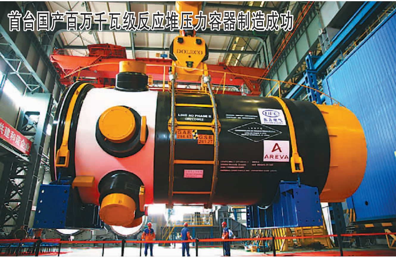
6月15日，我国首台国产百万千瓦级核电反应堆压力容器——岭澳二期项目4#机组反应堆压力容器在广州制造成功并顺利发运，这代表我国核电关键设备国产化取得重大突破。图为反应堆压力容器被吊装发运。 翟 莉摄（新华社发）
