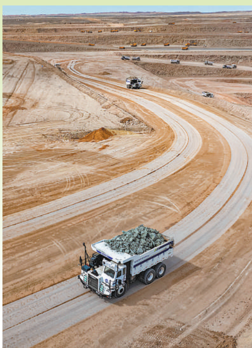
▲在新疆准东煤田五彩湾一号露天煤矿,中国能建易普力公司应用新能源设备,引入无人驾驶矿卡近百台,每年可降低二氧化碳排放量近4000吨。本报记者 张武军摄
