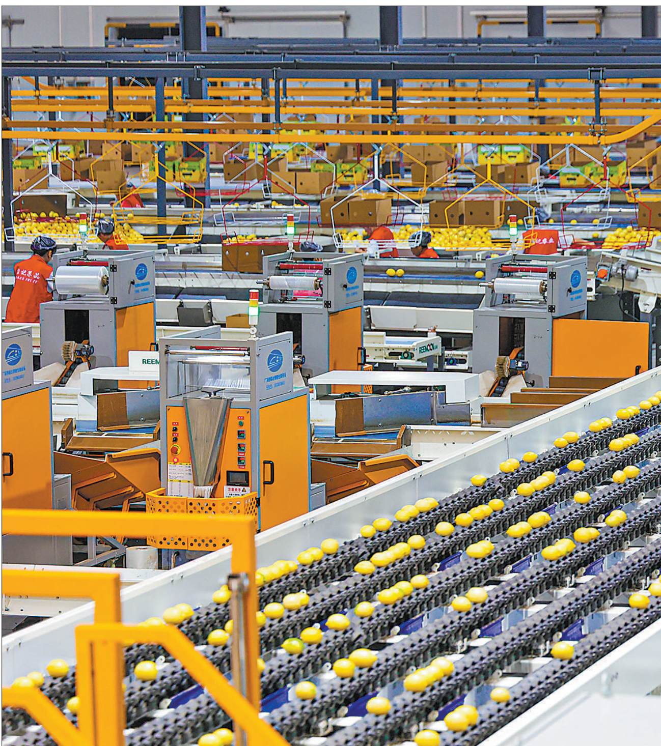
四川省资阳市安岳县被誉为“中国柠檬之乡”，近日当地柠檬陆续迎来丰收。图为10月17日拍摄的四川省维尼农业集团有限公司车间多功能六通道智能分选机。
