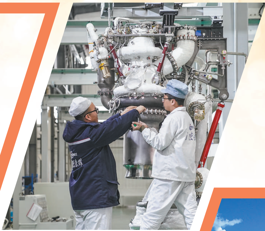
在北京星际荣耀空间科技股份有限公司，装配测试人员在装配液体火箭发动机。该公司加强自主研发，在商业航天运载火箭领域不断取得新突破。
