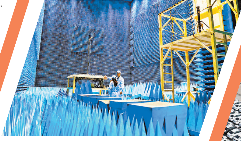
在中国科学院微小卫星创新研究院的微波暗室，科研人员正在进行卫星单机测试。
