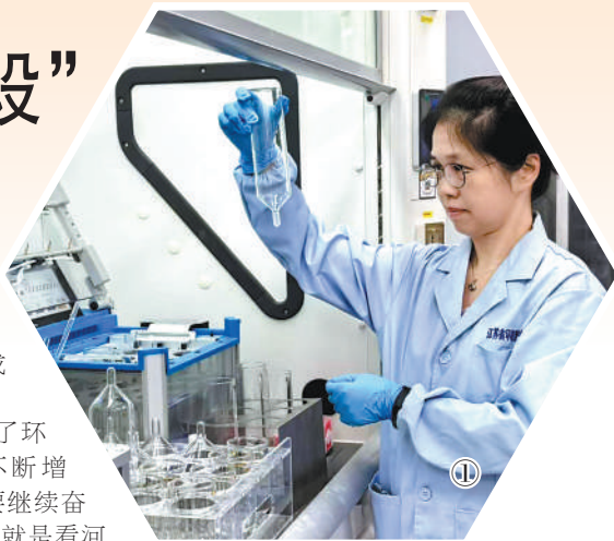
图①:胡冠九使用微量浓缩仪开展水样富集浓缩。张璜摄 图②:江苏省太湖水质监测中心站。
