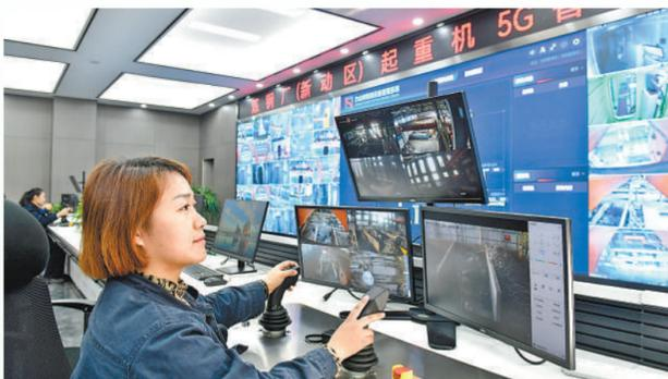
▲济南市钢城区，工作人员在山钢股份莱钢分公司炼钢厂起重机5G智能管控中心遥控操作吊运废钢。
