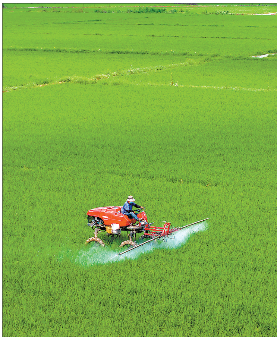
四川省眉山市彭山区观音街道崇兴社区千亩粮油基地，农机手驾驶喷杆喷雾机进行水稻病虫害防治作业。
