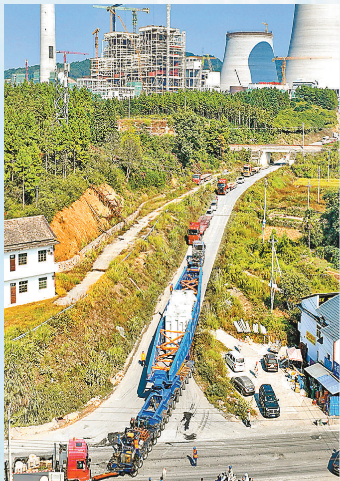
载有总重达505吨变压器的大件挂车抵达江西大唐国际新余发电有限责任公司。 朱海鹏摄(影像中国)
