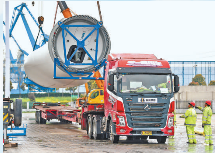
江苏省扬州港堆场,起重机将风电叶片吊装至特种运输车辆上。 方东旭摄(影像中国)
