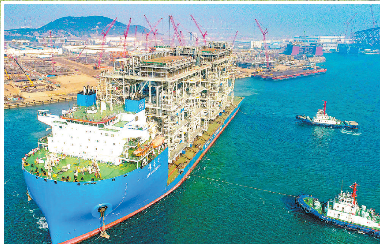
一体化建造的液化天然气模块化工厂从山东省青岛市运往国外。 张进刚摄(影像中国)
