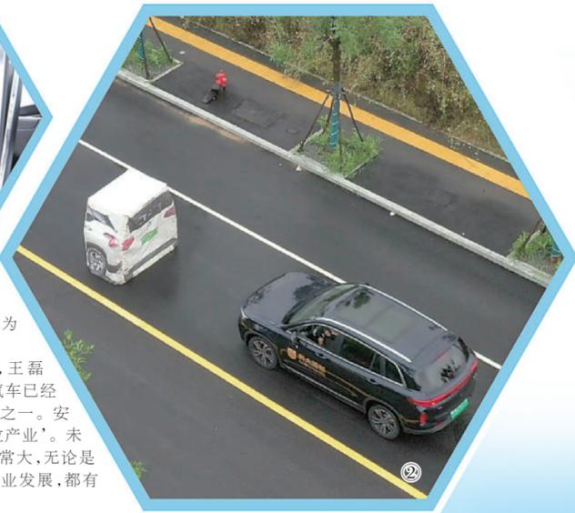
图②：测试场地内，智能网联汽车自动紧急制动功能测试正在进行。
