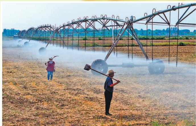
山东省临沂市郯城县归义农场,自移动式节水喷灌机在喷灌玉米田。
