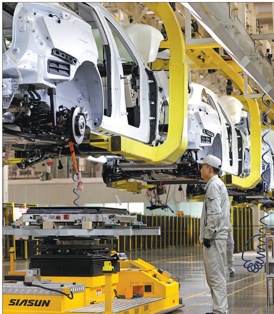
四川宜宾三江新区一家汽车公司总装车间内，新能源汽车准备安装电池包。
