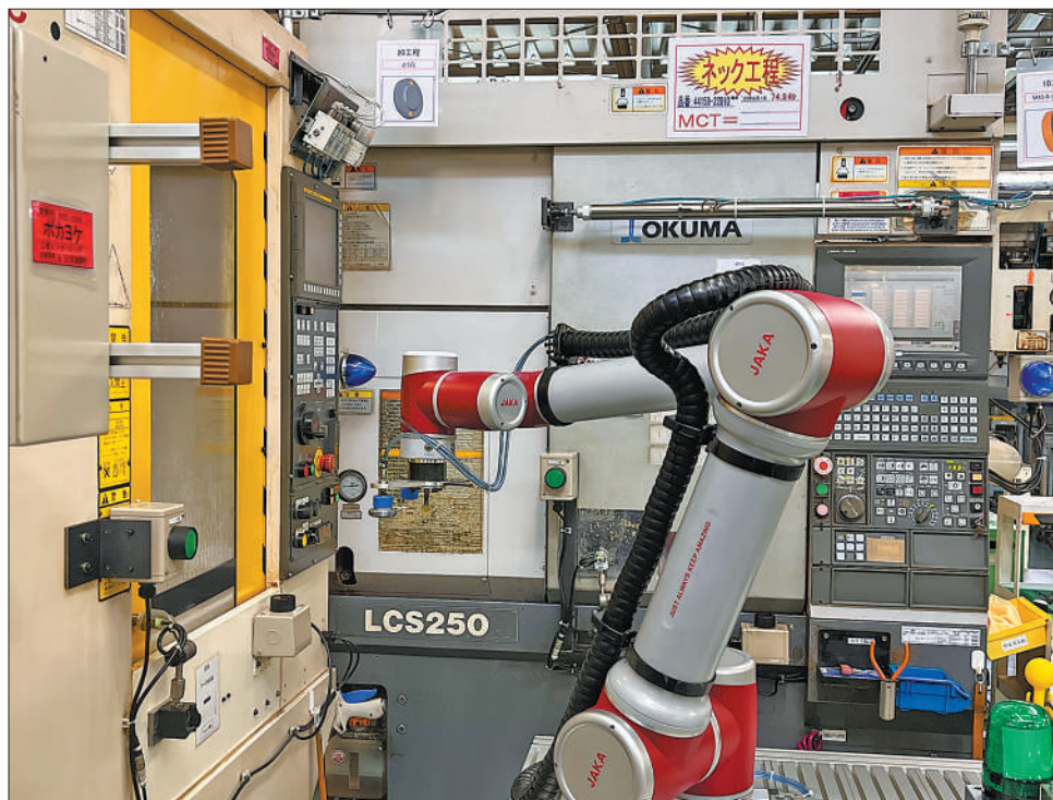
在日本一家工厂内,工业机器人正在加工汽车变速器工件。 本报记者 朱玥颖摄
