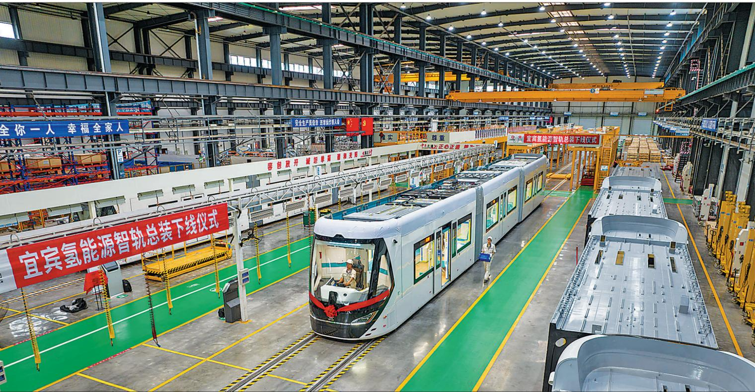
7月1日，在四川宜宾三江新区的中车铁投轨道交通产业基地生产车间，即将投入运营的首列氢能源智轨电车总装下线。相比已投运的新能源智轨电车，氢能源智轨电车具有续航里程更长、运营效率更高、更低碳排放环保的优势。
