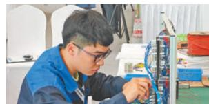
手持记号笔,目光如炬,只见轨道信号控制技术项目选手陈权(见上图,本报记者蒋雨师摄)在电路图上精准锁定电路,将一个接点逐一填入配线表,动作行云流水,一气呵成。在大赛现场,轨道信号控制技术项目选手需要完成轨道信号设备的设计、施工、调试与检修工作。就设计环节而言,选手们需要把上百条电路信号的转辙机电路设计图转换为电路配线表,但凡有一个接点错误,整个电路都将出现问题,而这一环节,陈权只花了10分钟。
