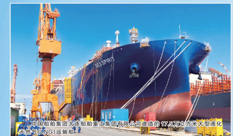
中国船舶集团大连船舶重工集团有限公司建造的17.2万立方米大型液化天然气(LNG)运输船
