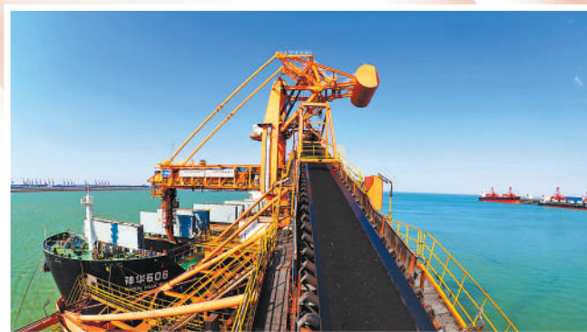
▲河北黄骅港煤炭港区,装船机正在进行智能装载。邵玉姿 苑立伟摄影报道
