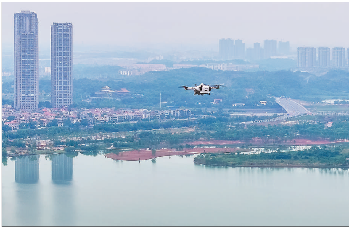
5月7日,一台装有货品的物流无人机在湖南长沙县上空飞行。近期,湖南首条常态化低空物流应用航线在长沙县开通,通过可载重4.5公斤、巡航速度60公里/小时的无人机,最大配送半径达7公里。今年,该项目预计在当地开通5至10条无人机物流配送航线,实现不低于1万架次的物流无人机飞行量。新华社记者 陈思汗摄
