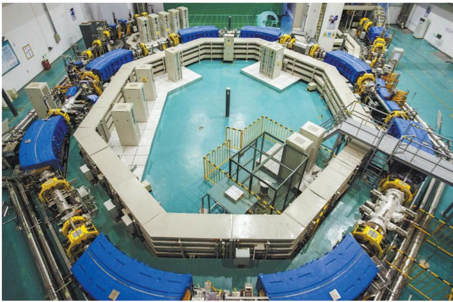
医用重离子加速器的核心系统同步加速器。
