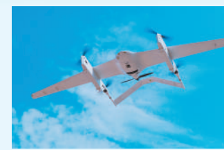
无人机搭载激光雷达开展数字孪生原型数据采集。
