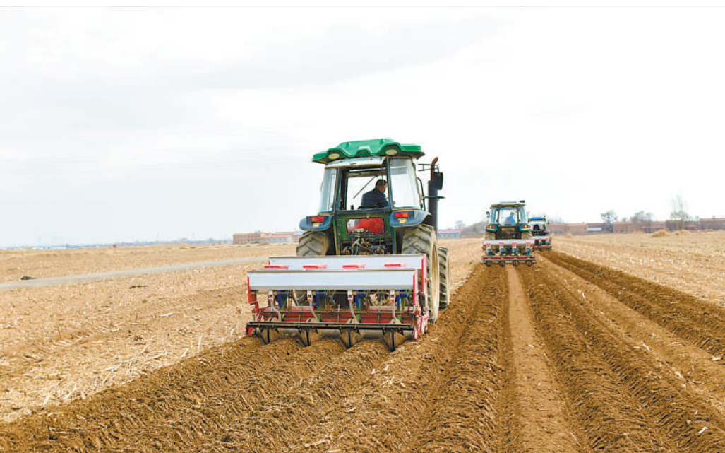
山西省长治市长子县，鲍店镇农民驾驶旋播一体机进行玉米播种。 焦博文摄(人民视觉)
