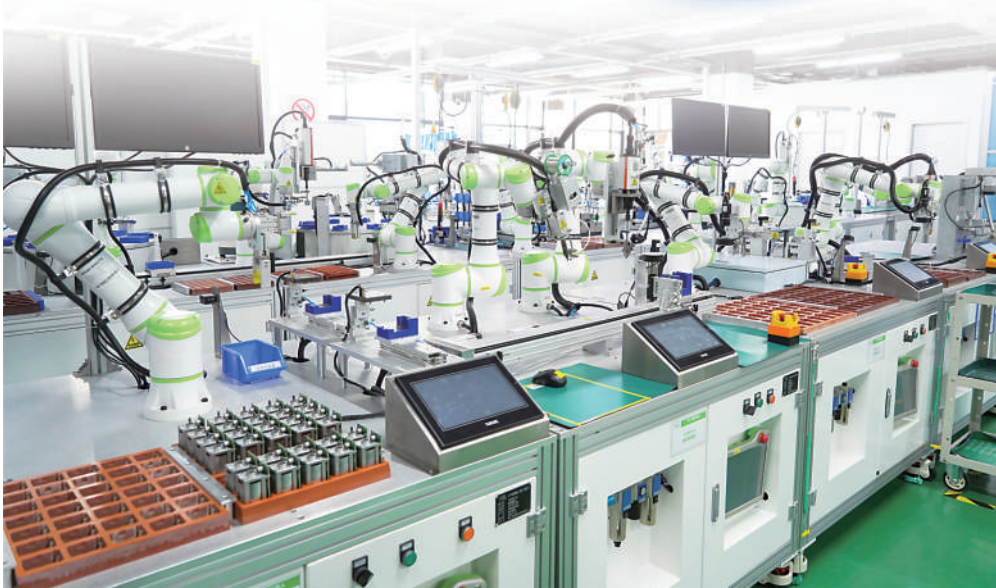
长广溪智能制造(无锡)有限公司的协作机器人在进行汽车智能部件自动装配。孙斌摄 数据来源：工业和信息化部等
