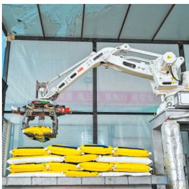
在新疆维吾尔自治区昌吉高新区的一处化肥生产车间内,生产线正开足马力,加紧生产各类肥料,为春耕生产提供有力保障。图为智能机器人在将生产出的水溶肥进行码垛。 陶维明摄(影像中国)
