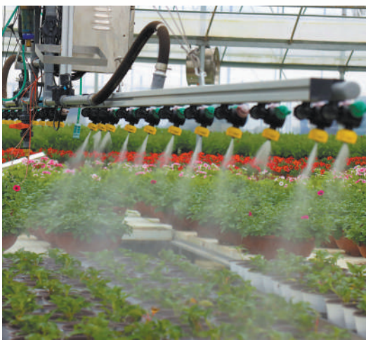
在湖北省宜昌市夷陵区一座智能育苗工厂内,自动喷水系统正在给蔬菜等种苗喷水保湿。近年来,夷陵区引进智能育苗和播种设备,提高种苗的生产效率。 李重庆摄(影像中国)
