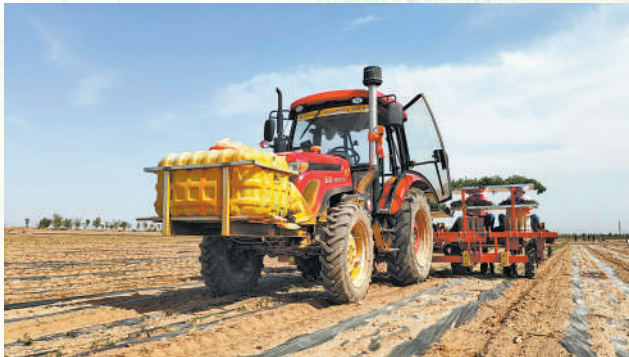
在甘肃省临泽县新华镇长庄村番茄种植基地里,装有北斗卫星导航系统的无人驾驶拖拉机正在将番茄苗植入田地。 赵帅杰 李 炳摄影报道
