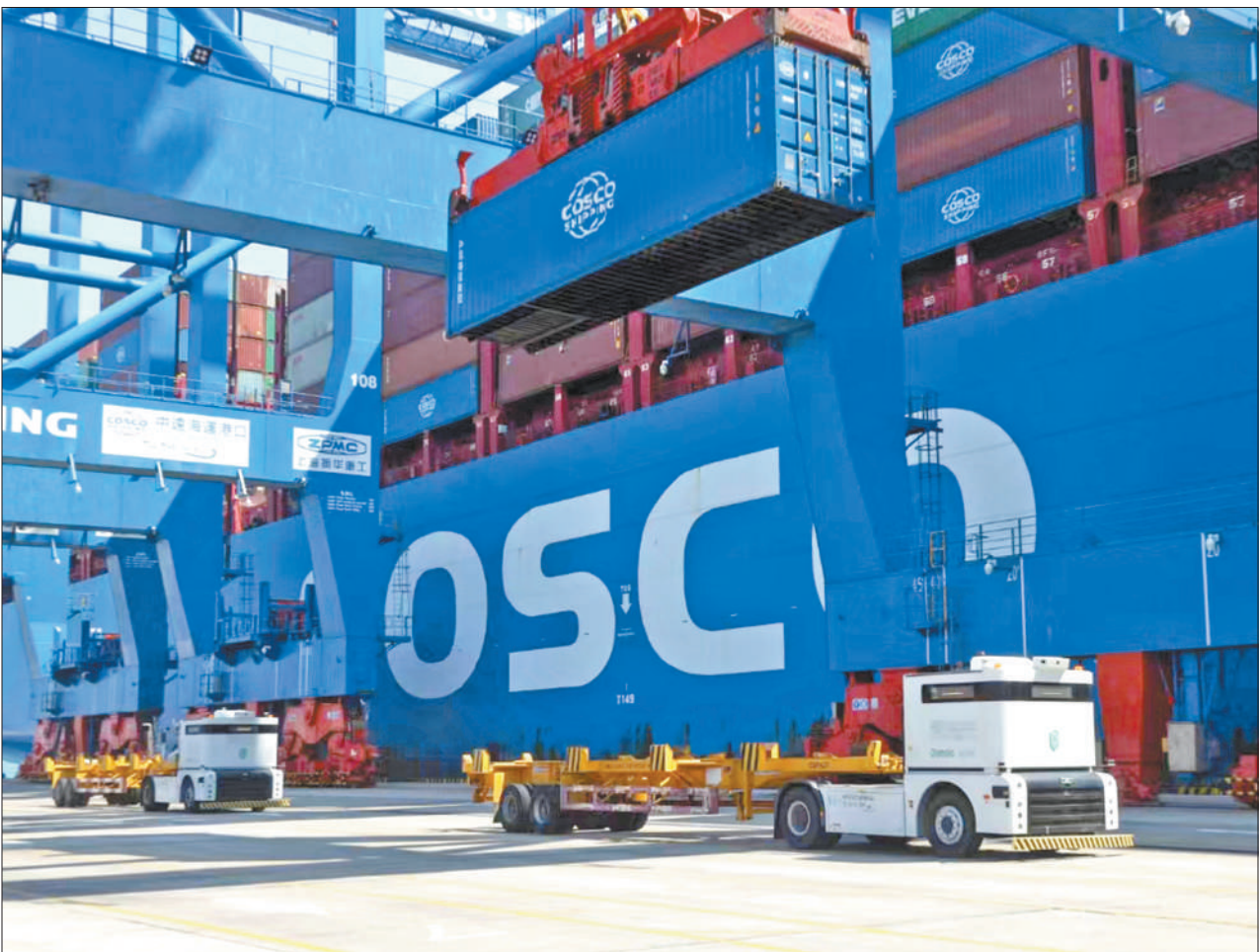
无人驾驶集装箱卡车正在中远海运港口阿布扎比码头作业。
