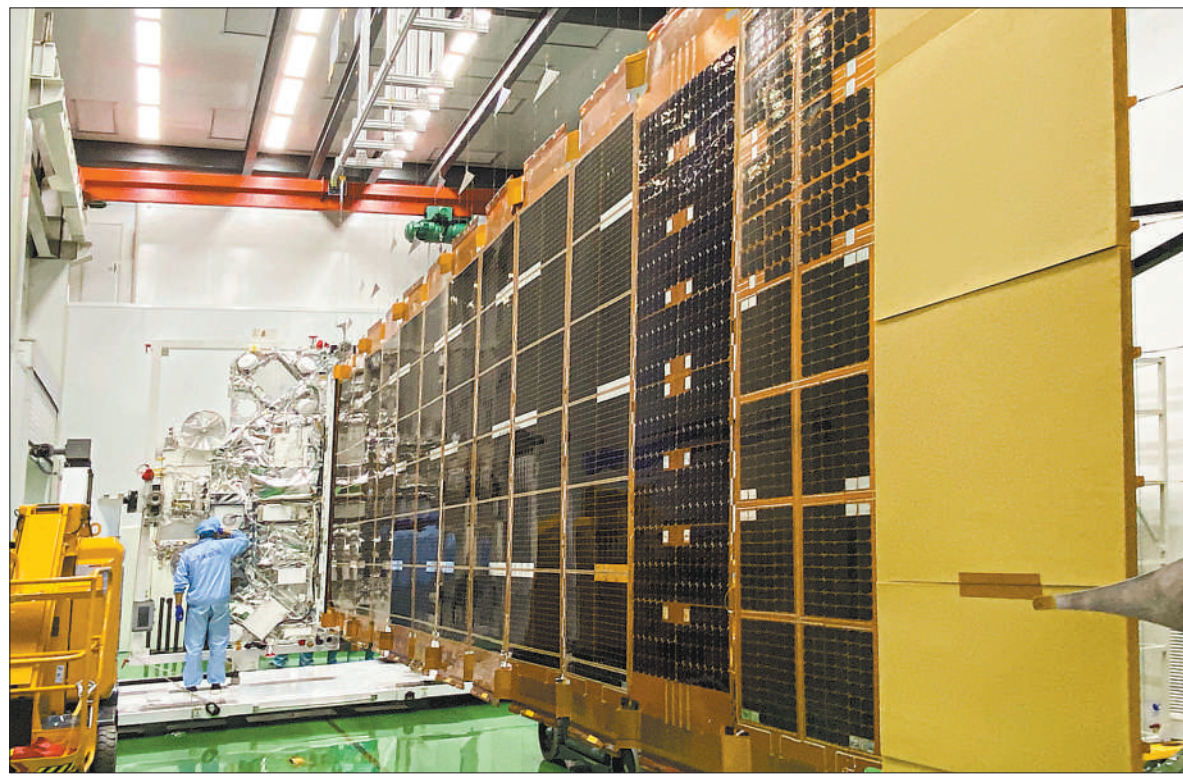
图为银河航天灵犀03星柔性太阳翼展开状态。
