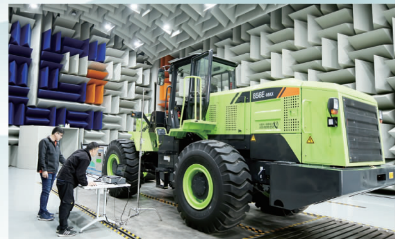
广西柳工机械股份有限公司积极开展工程机械声品质研究。图为公司员工在半消声实验室进行噪声测试
