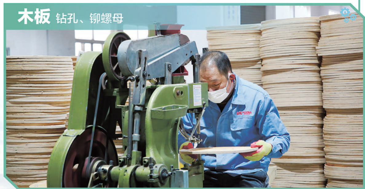
▲转椅木板钻孔、铆螺母生产线,一名工人正在进行铆螺母作业。
