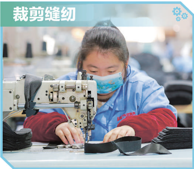
▲转椅缝纫生产车间,工人正在缝制转椅头枕套。
